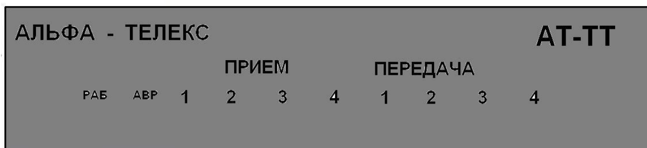
Рис. 6. Передняя панель телеграфного IP - шлюза «АЛЬФА-ТЕЛЕКС АТ-ТТ»
