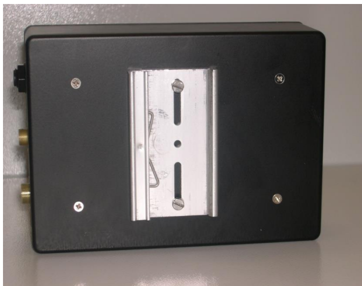
Рис. 1а. Вид аудиоконтроллера IA-10 сзади. Крепление на DIN-рейку.
