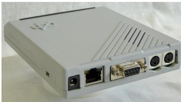
*Рис. 2. Задняя панель IOS-1 слева направо: разъем питания +48В, Ethernet RJ-45, COM-порт, аудиовыход, аудиовход.*
