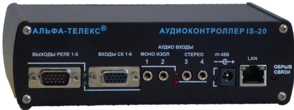
Рисунок 1 – Внешний вид лицевой панели аудиоконтроллера IS-20. Слева – направо: разъем дискретных выходов, разъем дискретных входов типа «сухой контакт», аудиовходы, разъем питания, разъем сети Ethernet, индикатор аварии.
