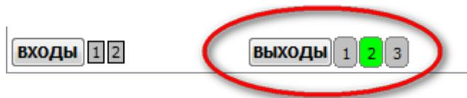
Серый цвет кнопки-индикатора означает, что выход неактивен (не включен). Если это выход по напряжению - значит напряжение отсутствует, если выход релейный – контакты реле разомкнуты. Зеленый цвет соответственно означает, что выход активен. Индикация состояния выходов обновляется даже при подключенном устройстве.
